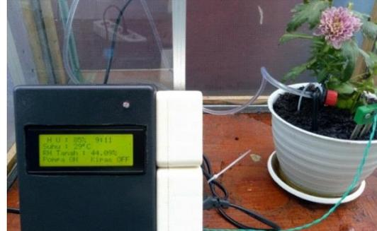
Jika kondisi tanah basah pompa akan mati secara otomatis.
